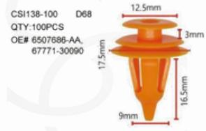
cabeza superior: 12.5mm. intermedia: 16 mm. inferior: 17.5mm. Diámetro vástago: 9mm. Longitud vástago: 16.5mm. Longitud total: 23mm.
