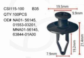
Ajuste Orificio: 7.9mm, longitud del tallo: 19.2mm, Tamaño de la brida: 19.5mm
