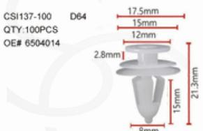
Diámetro cabeza inferior: 17.5mm, diámetro del tallo 8mm, longitud tallo 15mm, diámetro cabeza superior: 12mm.
