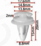
Diámetro superior 13.8mm; diámetro media: 14.8mm; diámetro inferior 17.6mm; longitud tallo 15 mm; diámetro tallo 8.8 mm
